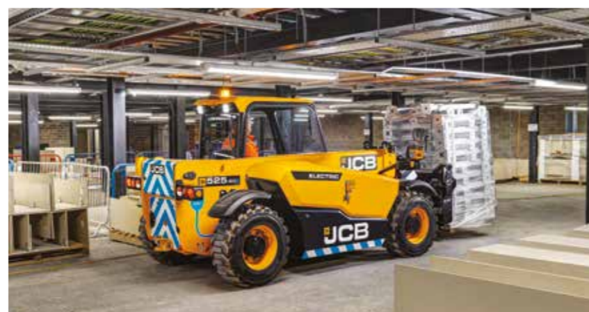
E-Mobilität im Baumaschinen-Segment. Zum Beispiel für geräuscharme und emissionsfreie Arbeiten in Innenräumen. JCB elektrifiziert dazu auch seine Teleskoplader-Ränge. Hier der neue 6 m Telesstapler 525-60E.
