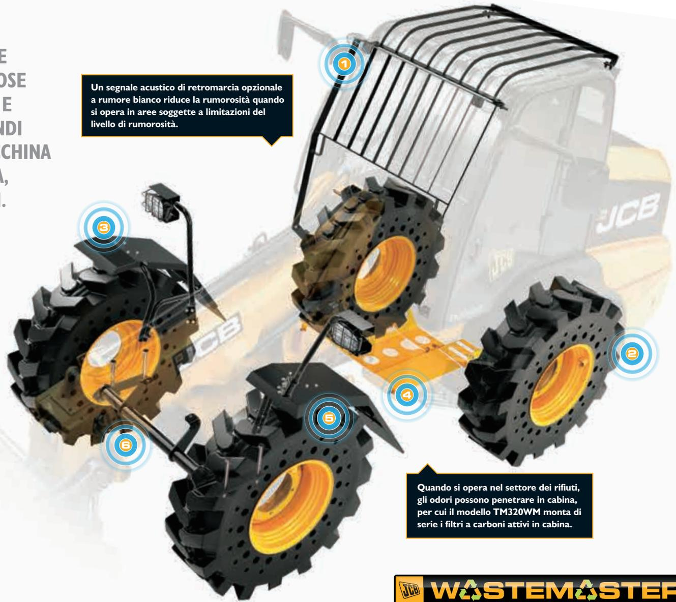
Quando si opera nel settore dei rifiuti, gli odori possono penetrare in cabina, per cui il modello TM320WM monta di serie i filtri a carboni attivi in cabina.
