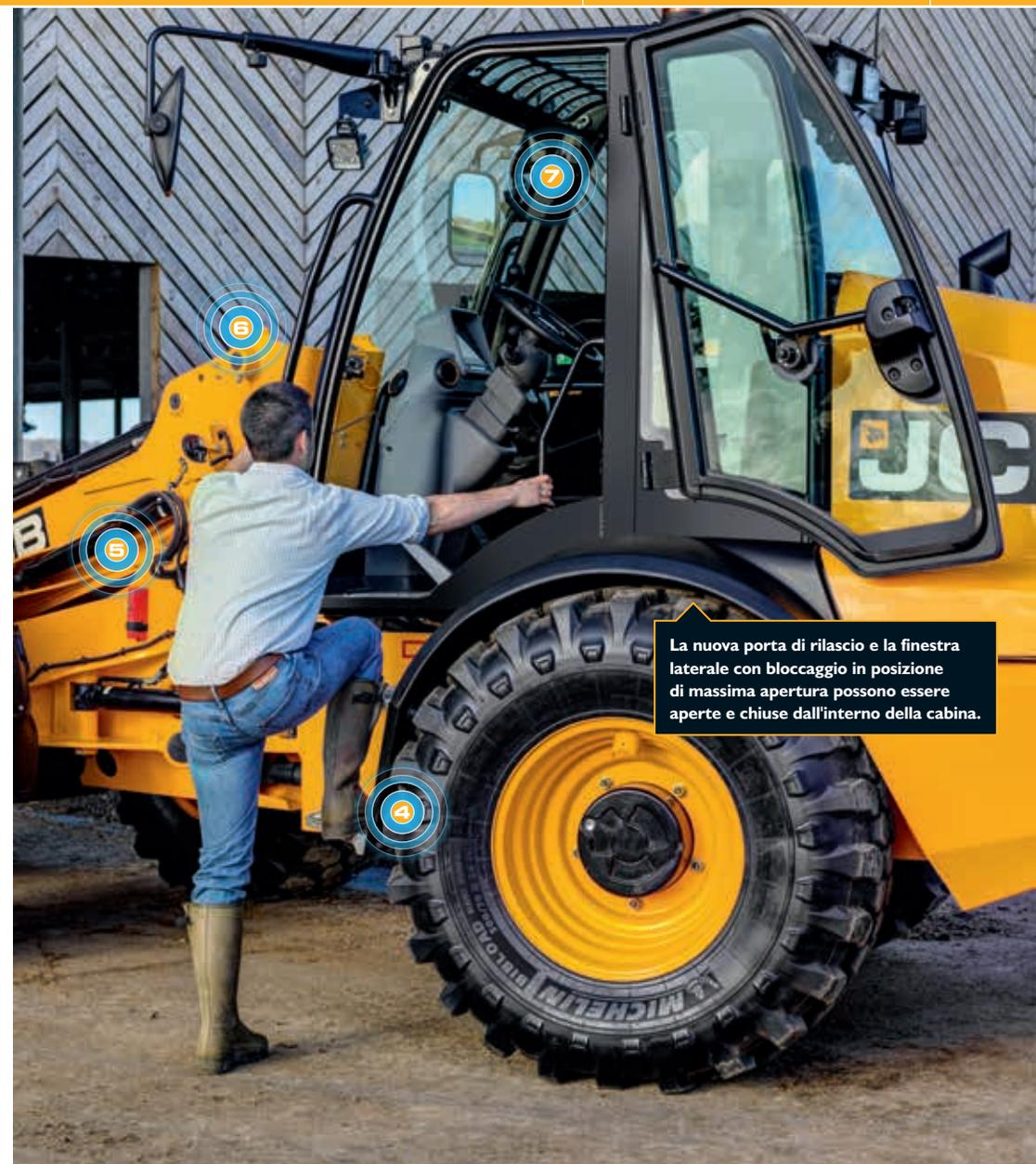
La nuova porta di rilascio e la finestra laterale con bloccaggio in posizione di massima apertura possono essere aperte e chiuse dall'interno della cabina.
