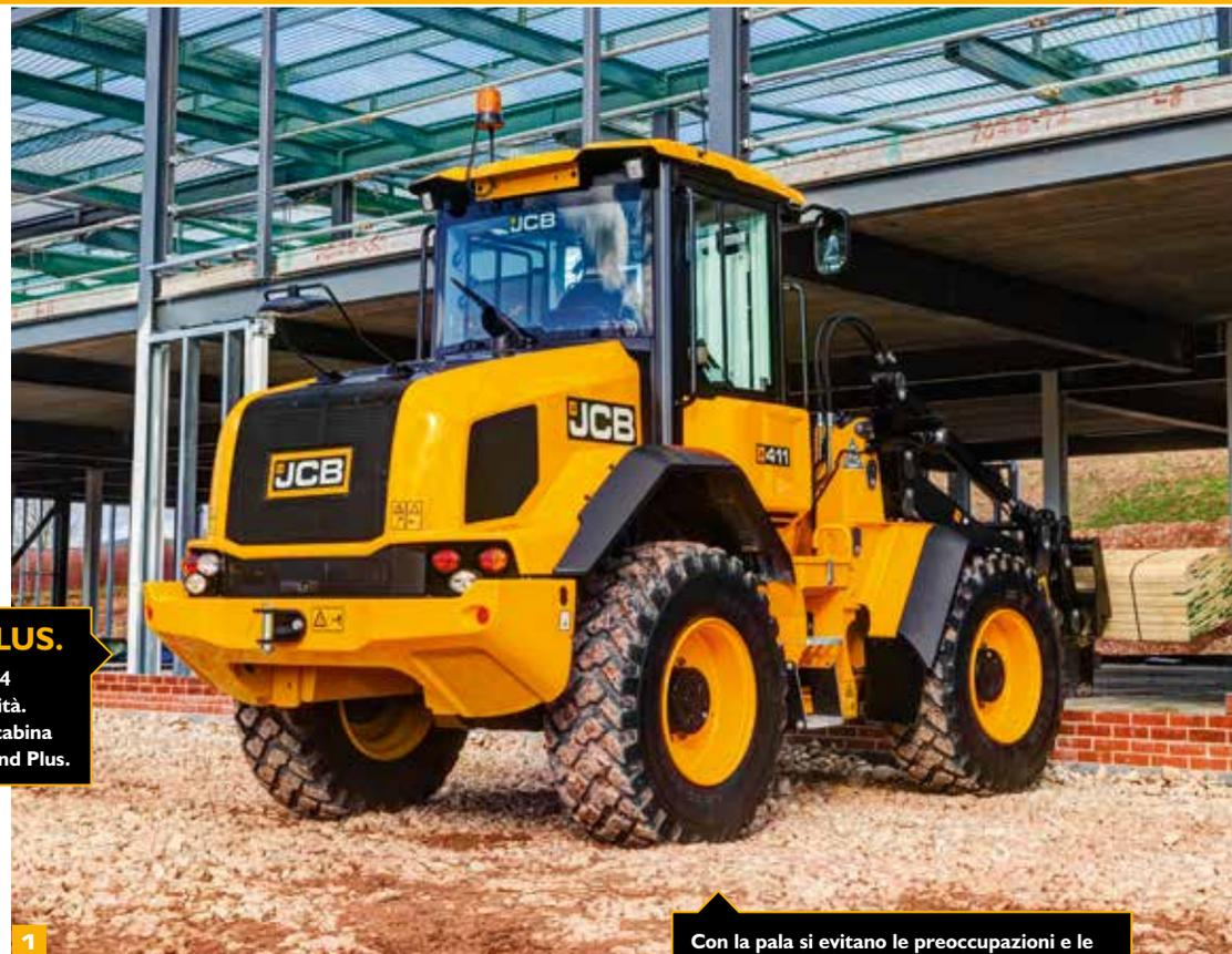
Con la pala si evitano le preoccupazioni e le perdite di tempo e denaro per sostituire il filtro antiparticolato (DPF); il motore EcoMAX è conforme alla normativa Tier 4 Final/Stage IV in quanto utilizza solo il ricircolo dei gas di scarico (EGR) e il sistema di riduzione catalitica selettiva (SCR). Questo comporta anche un risparmio di carburante.
