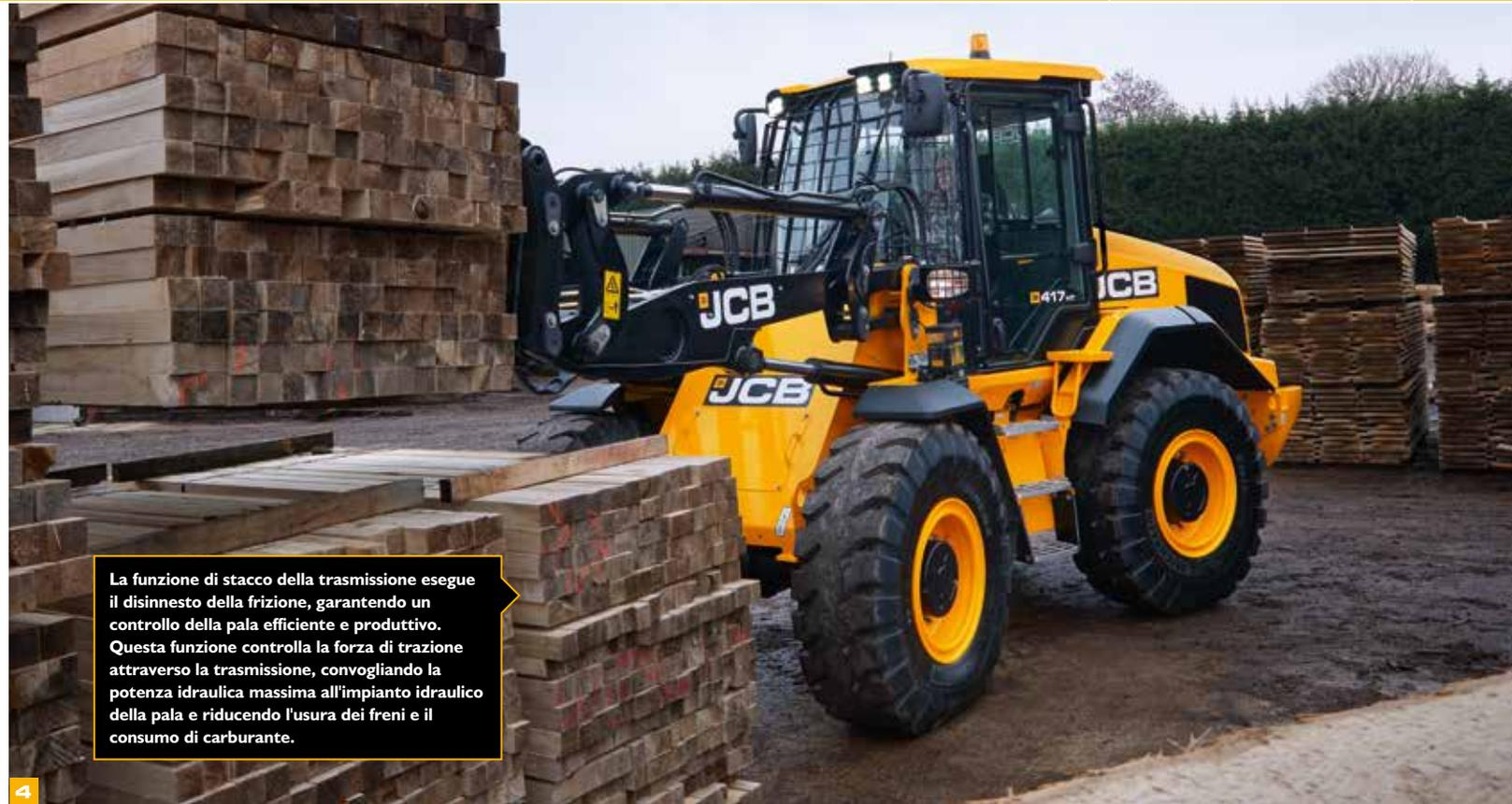
**La funzione di stacco della trasmissione esegue il disinnesto della frizione, garantendo un controllo della pala efficiente e produttivo. Questa funzione controlla la forza di trazione attraverso la trasmissione, convogliando la potenza idraulica massima all'impianto idraulico della pala e riducendo l'usura dei freni e il consumo di carburante.**
