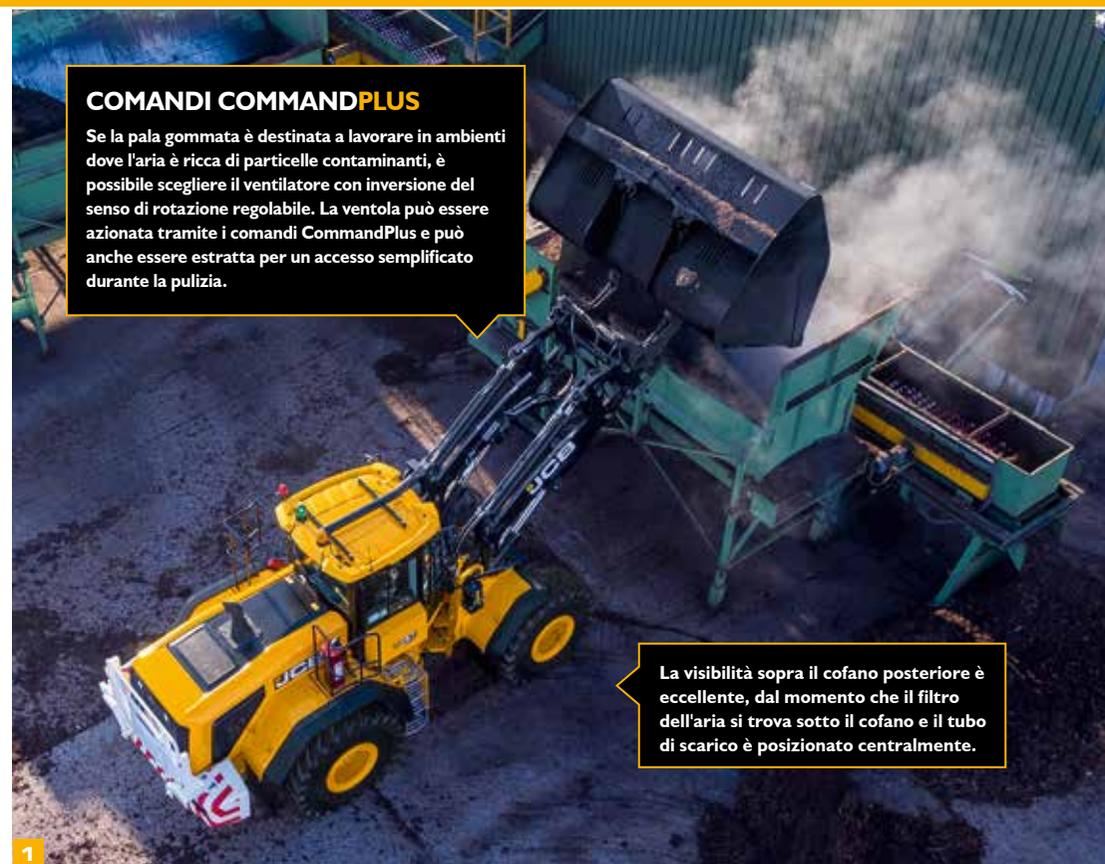
La visibilità sopra il cofano posteriore è eccellente, dal momento che il filtro dell'aria si trova sotto il cofano e il tubo di scarico è posizionato centralmente.
