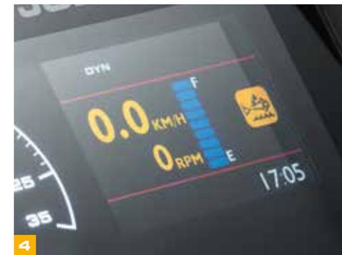
Una nuova funzione di spegnimento automatico del motore, quando lasciato funzionare a regime minimo, consente di ridurre il consumo di carburante. Il tempo di funzionamento a regime minimo può essere impostato dal sedile della cabina.
