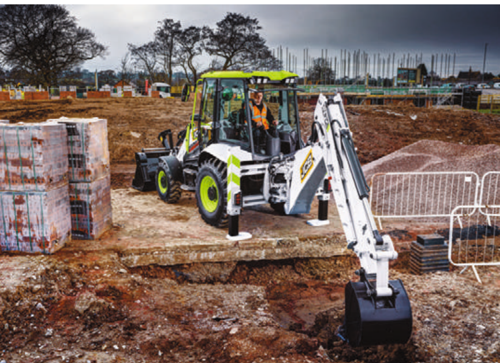
Im Prototyp dieses JCB Baggerladers arbeitet ein modifizierter Dieselmotor, der mit Wasserstoff betrieben wird und damit keine Emissionen verursacht.
