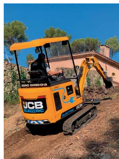
Malgré le poids de ses batteries à l'arrière, la 19C-1E peut grimper sur une forte pente en marche avant. L'équilibre spécifique de l'engin peut toutefois inciter à monter plutôt en marche arrière.
