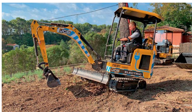
Une manœuvre effectuée avec la minipelle électrique JCB 19C-1E de 1,9 t, utilisée ici pour rassembler les déchets broyés au sol.
