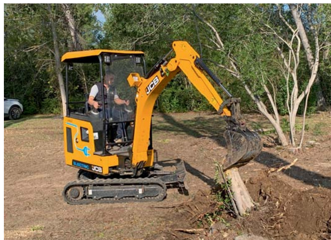
La force d'arrachement de la minipelle 19C-1E de JCB permet ici de retirer des souches d'un diamètre maximal de 45 cm.
