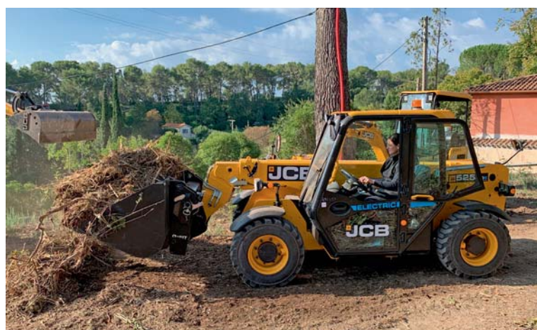
Le chargeur électrique Telescopique JCB 525-60E possède une batterie Li-ion de 96 V lui permettant de fonctionner une journée complète.
