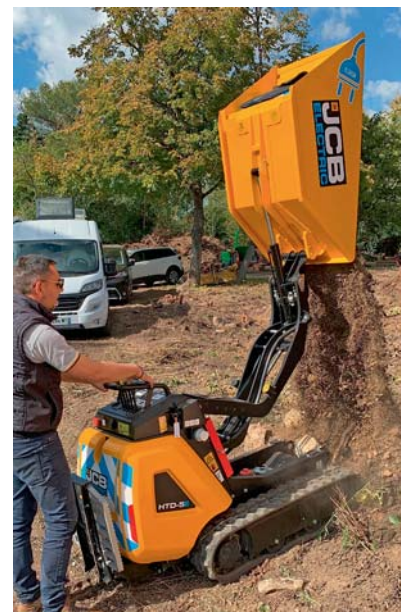
D'une charge utile de 500 kg, ce dumpster HTD-5E ultracompact (train de chenilles de 85 cm) peut benner jusqu'à 2,7 m de hauteur.
