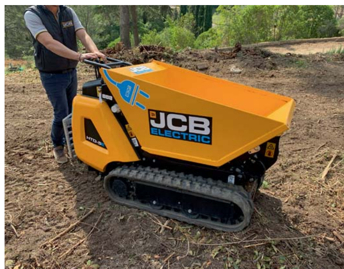
Le gabarit et le poids contenu du minidumper HTD-5E, appelé « dumpster » par JCB, se sont ici révélés utiles, évitant d'endommager des surfaces fragiles.
