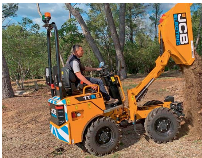
Le dumper 1TE peut déverser les matériaux jusqu'à une hauteur de 2,39 m.
