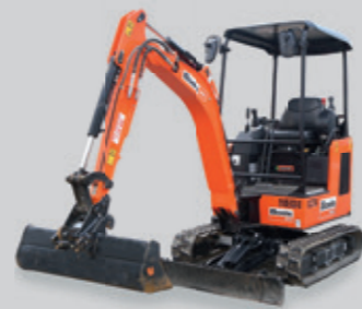
JCB E-Tech Minibagger arbeiten abgasfrei und geräuscharm
